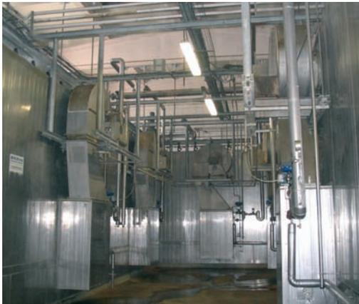
Foto. 7. Máquina de escaldado vertical
