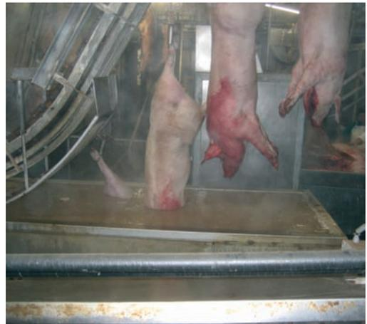
Foto. 8. Escaldado horizontal en tanque
